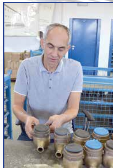
ДУШАН СТОИМЕНОВ ПОСЛЕ КОНТРОЛИСАЊА ПОСТАВЉА ЖИГ НА ВОДОМЕРЕ
