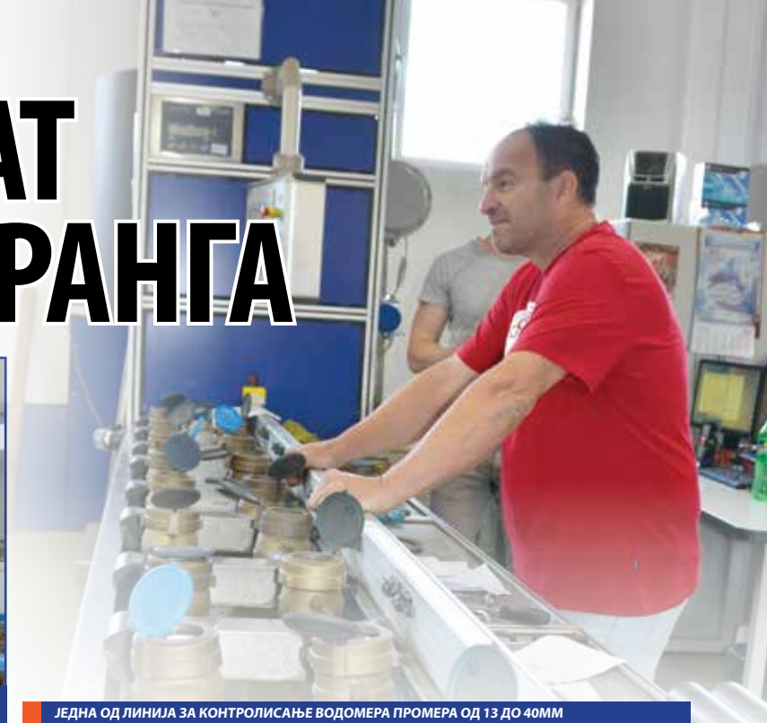
ЈЕДНА ОД ЛИНИЈА ЗА КОНТРОЛИСАЊЕ ВОДОМЕРА ПРОМЕРА ОД 13 ДО 40ММ
